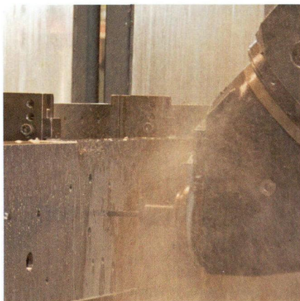
图 3 XXL 移动柱式铣床拥有一个可在两个水平上自动回转的通用铣头
