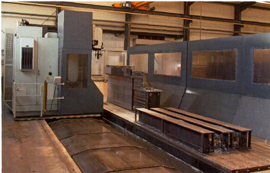
图 1 带有 40 道刀具更换装置的移动柱式铣床取代了已经使用 20 多年的老旧铣床
