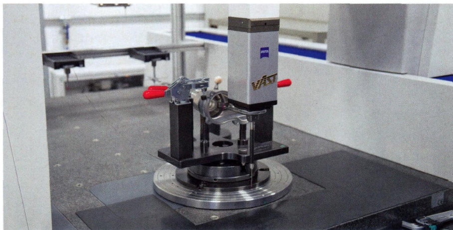
图 3 ZEISS PRISMO 桥式三坐标测量机
