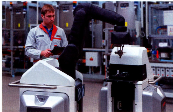
图 2 由于有传感器外壳，该名为“Apas assistant”的移动助理装置适用于与人合作进行生产作业
