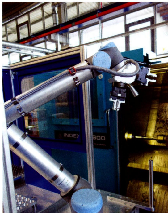
图 3 人与机器人之间不设防护围栏：轻型机器人承担装备机床的作业
