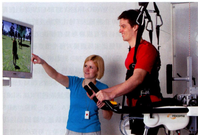
图8 Lokomat 运动器是一部机器人支持的步行矫正器
