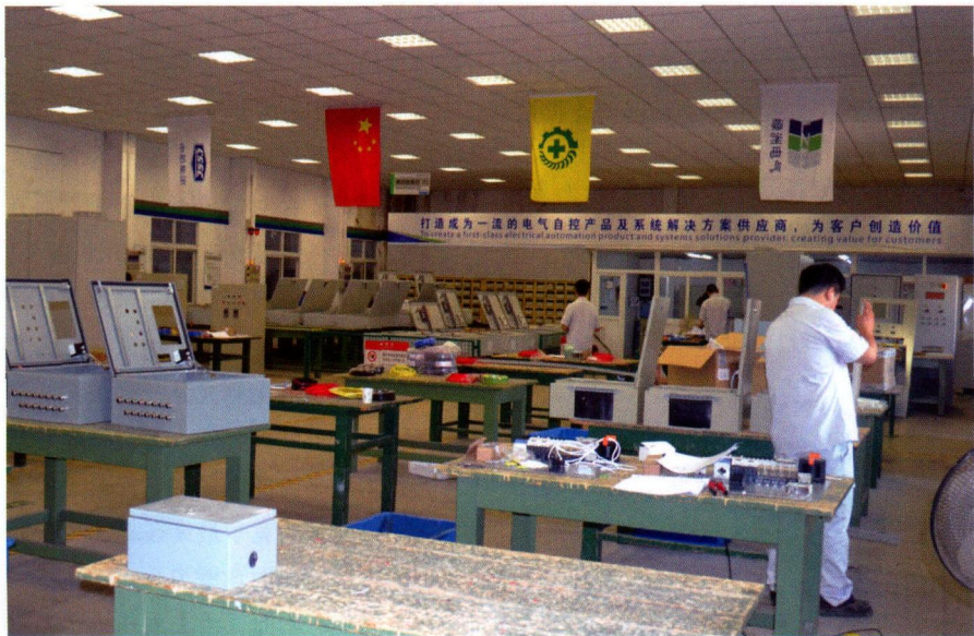
图 1 绿洲电气预组装多个控制柜，到船上只需进行现场连接和调试便可投入运行
