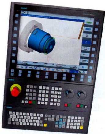
图2 Sinumerik 操作控制表面无论是用于车加工、车铣加工或是铣加工的形式均相同
