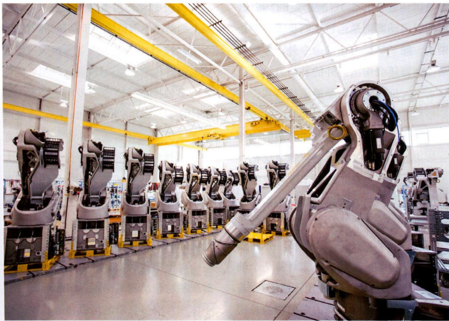
图 1 汽车行业使用的喷漆机器人必须特别结实耐用。喷漆机器人必须具有很高的灵活性，这便对所使用的线缆和电路提出了极其高的要求
