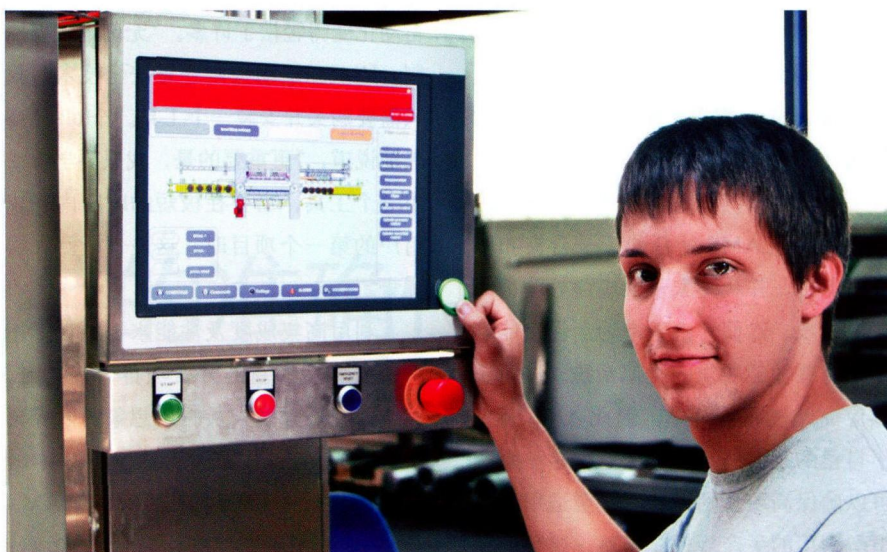
图 2 AMS 公司自动化控制程序员 Stephan Holzer 表示: “贝加莱 Automation Runtime 操作系统运行在不锈钢的 Power Panel 500 控制器上, 它可以通过 RFID 应答器登录。”
