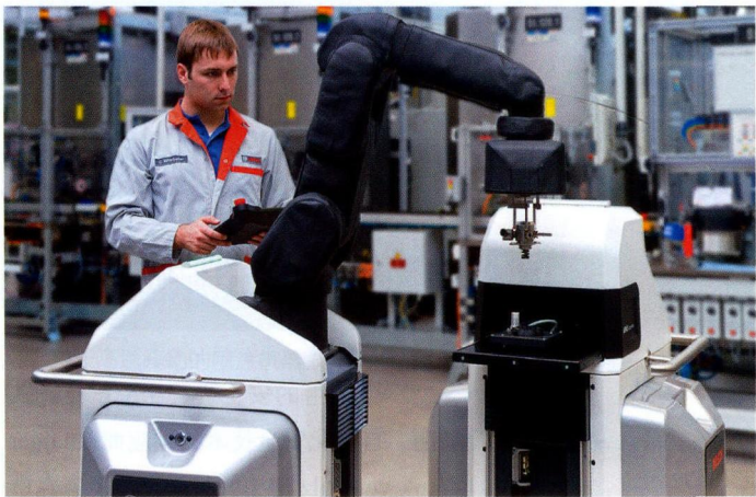
图 2 由于有传感器外壳，该名为“Apas assistant”的移动助理装置适用于与人合作进行生产作业
