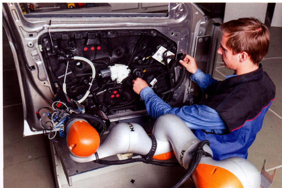
图 1 在 Arena2036 产品中，弗劳恩霍夫制造技术和自动化研究所研发了一种灵活的组装模式，工人和机器人可以在合作中发挥其相应的能力
