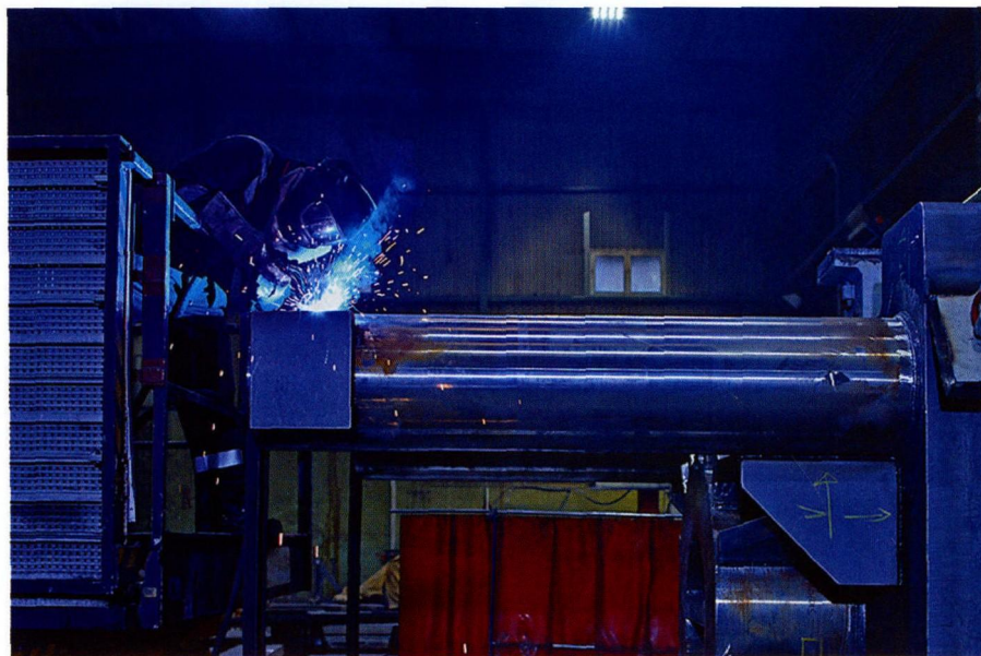
图 有资质的员工参照 ISO 9606 标准认证、材料质量 S960 许可进行焊接检验，是 Jebens 能够参照 DIN EN 1090 2 EXC 4 和 ISO 3834 标准完成认证的前提
