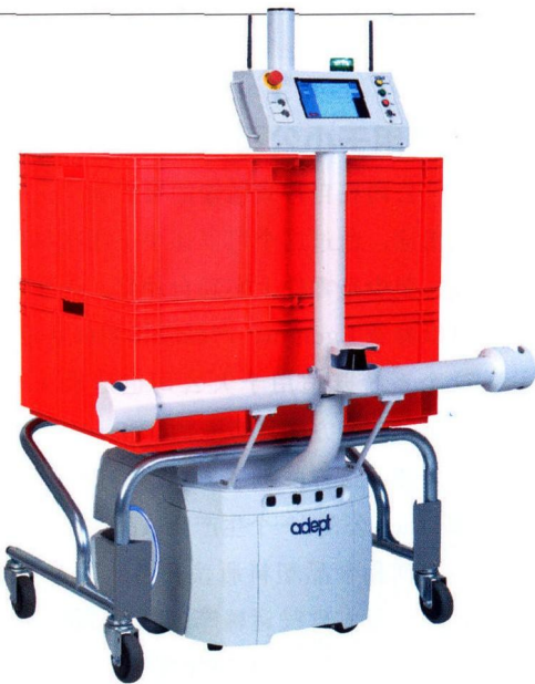
图4 Adept Lynx Cart 运输机是一个集成的无人驾驶运输系统, 净载重量 130 kg
