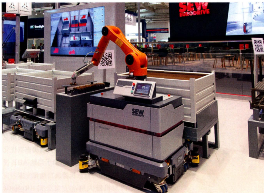
图 SEW-Eurodrive 公司的移动式搬运机器人可以抓取无序摆放的工件，并使其有序放置，以利于进一步加工
