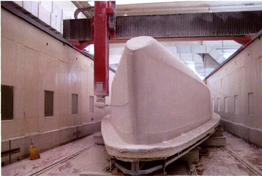
图 1 Belotti 加工中心加工 20.37 长船体，公差仅 1 mm
