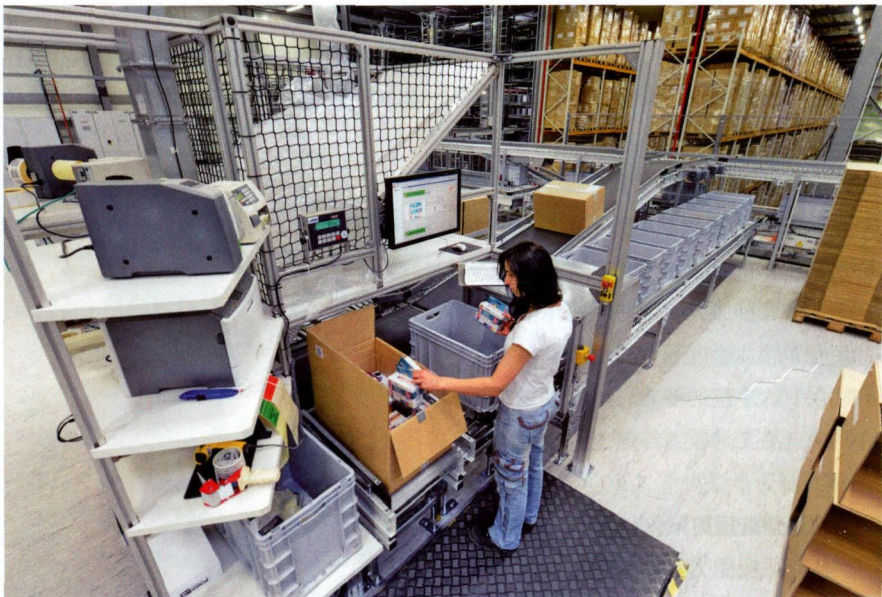
图 1 德马泰克为 FWM 提供了其在全球建造的第一批多层穿梭车货到人拣选系统
