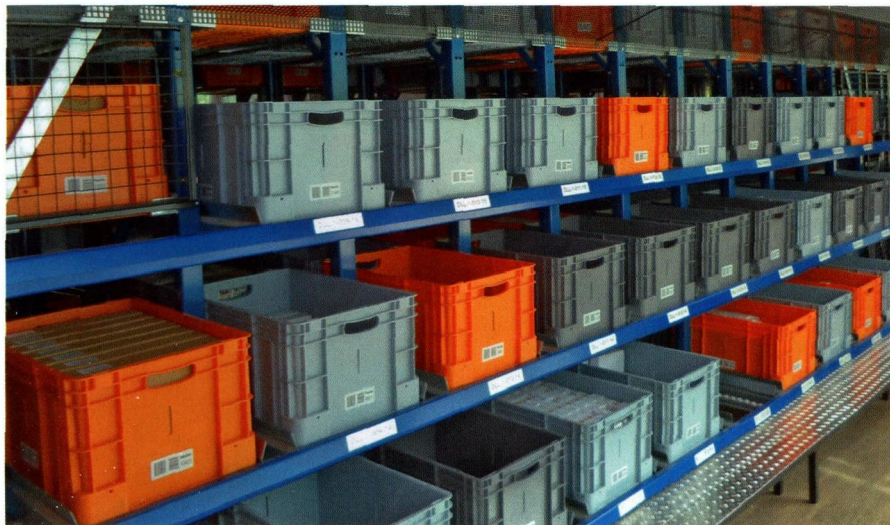
图2 在连续性货架里,借助于无线电扫描仪手工进行发货的运作处理,借助打印使用说明书,将货物送到包装工位并出具发货文件
