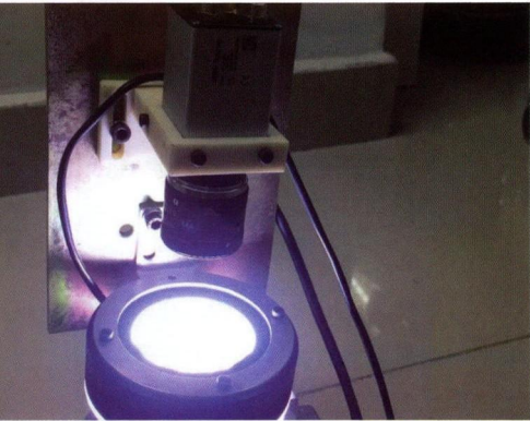
图 2 堡盟工业相机检测工作中
