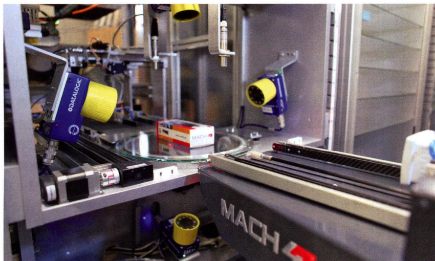
图 1 存入药品物流自动化装置的药品可以以任意顺序进行分类，由 4 台相机协助识别条形码或 2D 码
