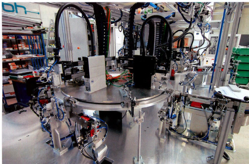
图 1 针对 UBH 机械工程公司机电传感器的自动组装器带有 Weiss 的部件：3 个旋转分度台和 11 个直接驱动的取放单元在 1.5 s 的周期内可达到 0.02 mm 的定位精度
