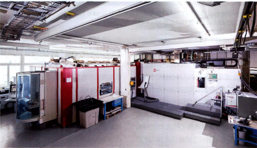
图 2 柔性加工系统配备了 C50 U- 加工中心（右）和 RS3 机器人和工件仓库系统，左边可以看到托盘准备工位
