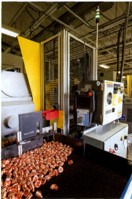
图2 将锻件坯料从包装箱倒到散装式供料台上，完成定位并通过擒纵机构，将坯料输送到机器人的拾取位置
