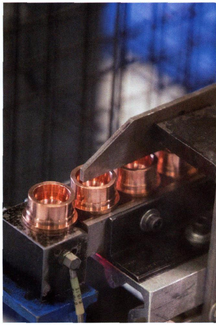
图3 这张照片显示了将零件在线输送到机器人的拾取槽
