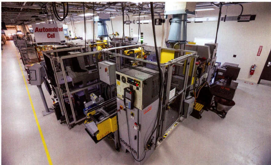
图 1 Hypertherm 公司的机扑加工单元包括两台瑞士型 Tsugami 数控机床，两台 FANUC LR Mate 200id 工业机器人以及两部 FANUC M-10iA 机器人
