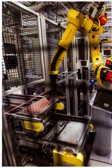
图4 将已加工零件从机床上卸下，并放置到第二台机器人，清洗和检测设备用于完成批次结束时的零件检验，并向监视器分享两台相同加工单元的生产情况
