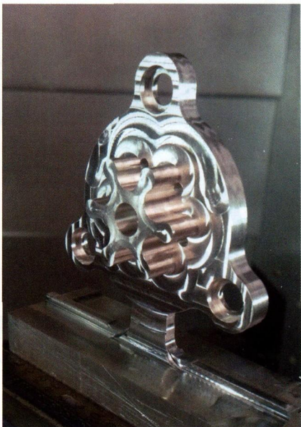
图 4 还未被验证和确认的原型机零件需要快速和精确制造，要达到这一目的，其中一种方法就是在一次加工作业中加工多个零件，将容易切削掉的小板留在零件底部
