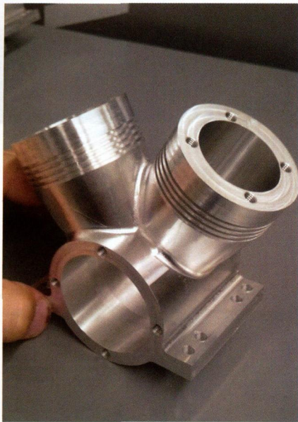
图 2 在 购买了 WorkNC 之前，Performance Motion 公司并不能生产四冲程无线电控制汽车发动机的这台已完工发动机缸体，对于这类零件，必须进行碰撞控制
