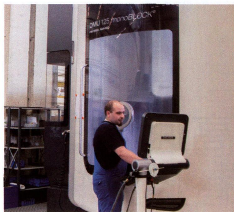
图3 DMG MORI gearMILL® 软件搭配上 Zahnradwerks Pritzwalk 公司选用的 DMU 125 monoBLOCK®, 一台机床就能完成全部加工并提高生产力
