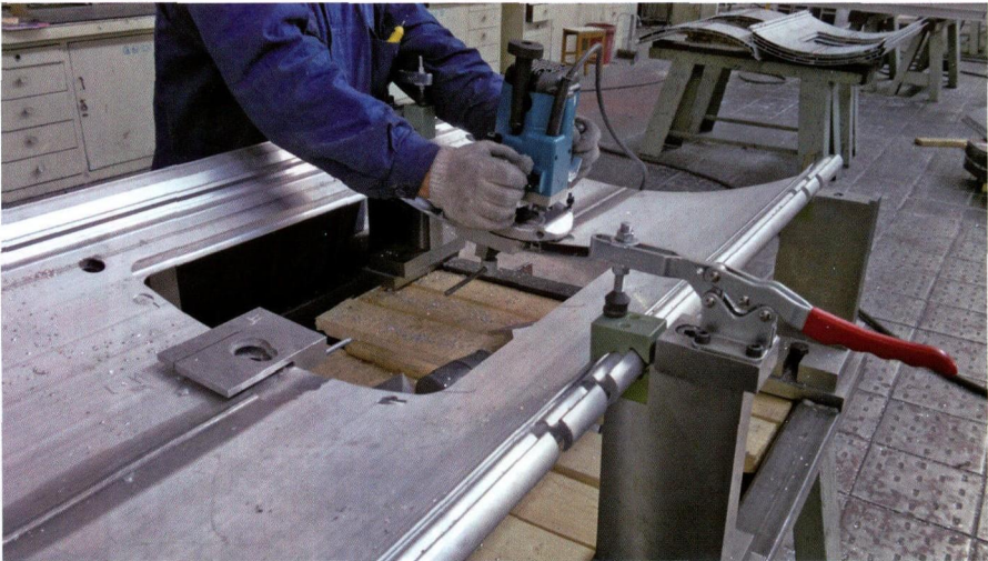
采用雕刻机和专用仿形工装加工高速动车组等轨道车辆的裙板
