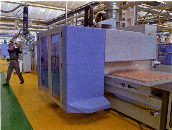
图3 Capron 公司的木材加工中心是利用真空压紧技术来压紧胶合板的
