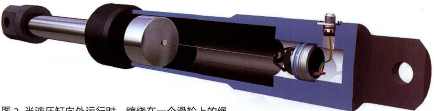
图 2 当液压缸向外运行时，缠绕在一个滑轮上的绳索将会被拉出，由此产生的滑轮旋转动作将会被传感器电子元件无接触地记录下来
