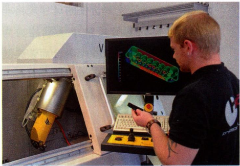
图2 为了满足在产品生产过程中的缩孔和跟踪理想的几何尺寸的需要，Hörl 公司采用 X 射线技术对 3D 和 CAD 模型进行产品的初检和最终检查
