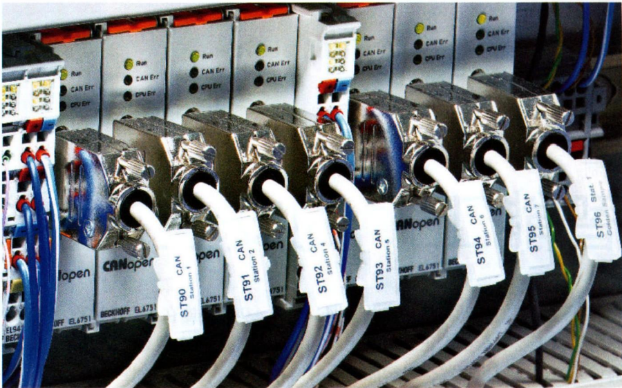
图 2 通过 7 个 CANopen 主站端子模块 EL6751 实现与测试设备之间的通信（符合 ISO 15765 标准），与现有的解决方案相比，成本降低了 80%
