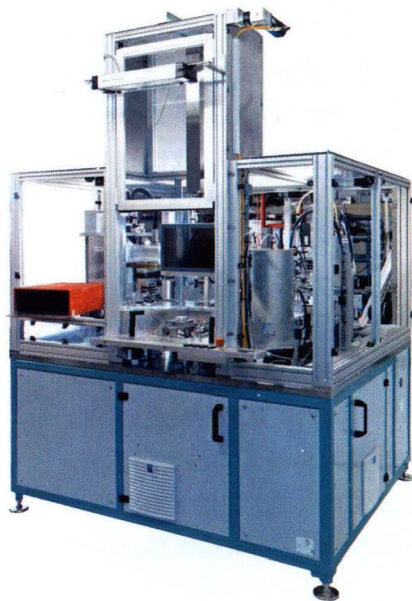
图 1 由于采用了基于 PC 的高性能控制技术并集成了高端测量技术，下线测试仪的结构非常紧凑
