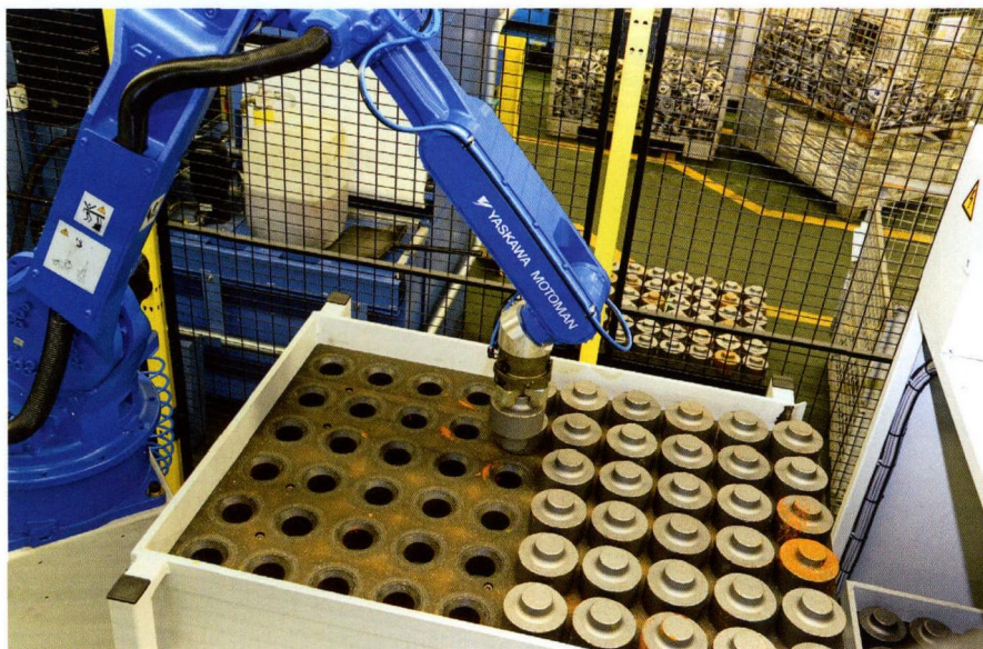
图 3 HP20D 型机器人将工件坯件从一个托盘上取出并将其转送到车加工中心
