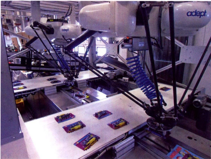
图 3 像飞过一样迅速便完成了广告宣传品粘贴作业：两台 Delta 机器人从供料传送带抓起广告宣传品，并用喷气动量将其粘贴在杂志输送带上运行过来杂志上
