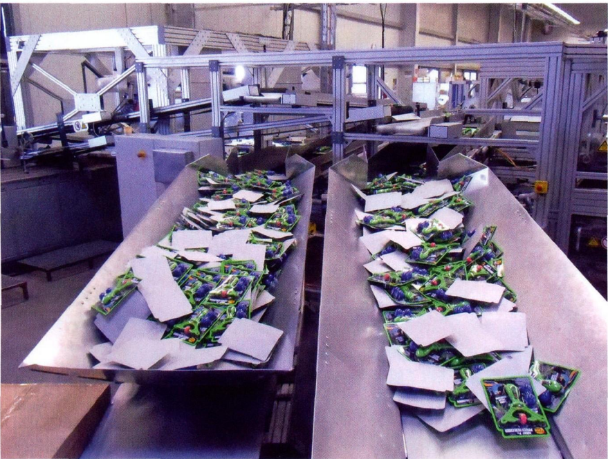
图 1 将一个纸板箱里的玩具产品倾倒在一個储藏仓里，分成一份一份的、单独、充分地整理出条理，并以一定的距离送到供料传送带上
