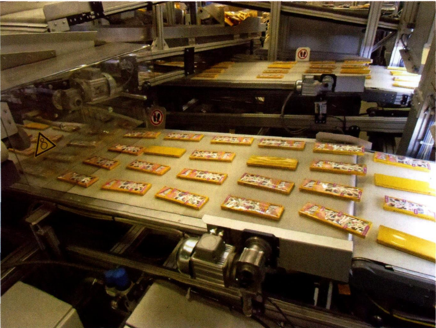
图 4 设置在一个相机地道里的图像处理装置完成广告宣传品产品的识别并确定其在送料传送带上的位置
