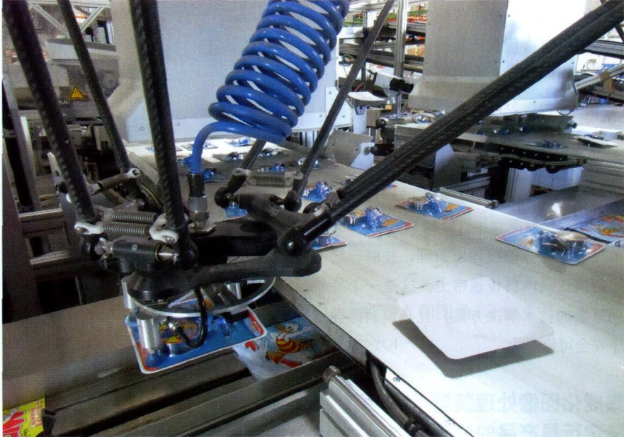
图 5 Delta 机器人在杂志传送带上方与那份杂志短时间共同运行，并用喷气动量将广告宣传品按照能够达到的定义的位置放在一个规定的小的粘贴点的位置上
