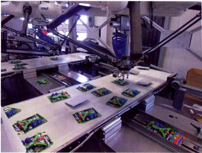
图 2 机器人用一真空抓斗抓起供料传送带上的广告宣传品
