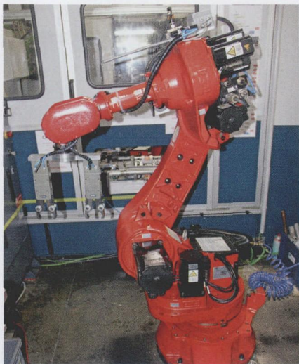
图3 一台 NS12 型机器人用于冲压车间对 Audi 转向柱制造的场合
