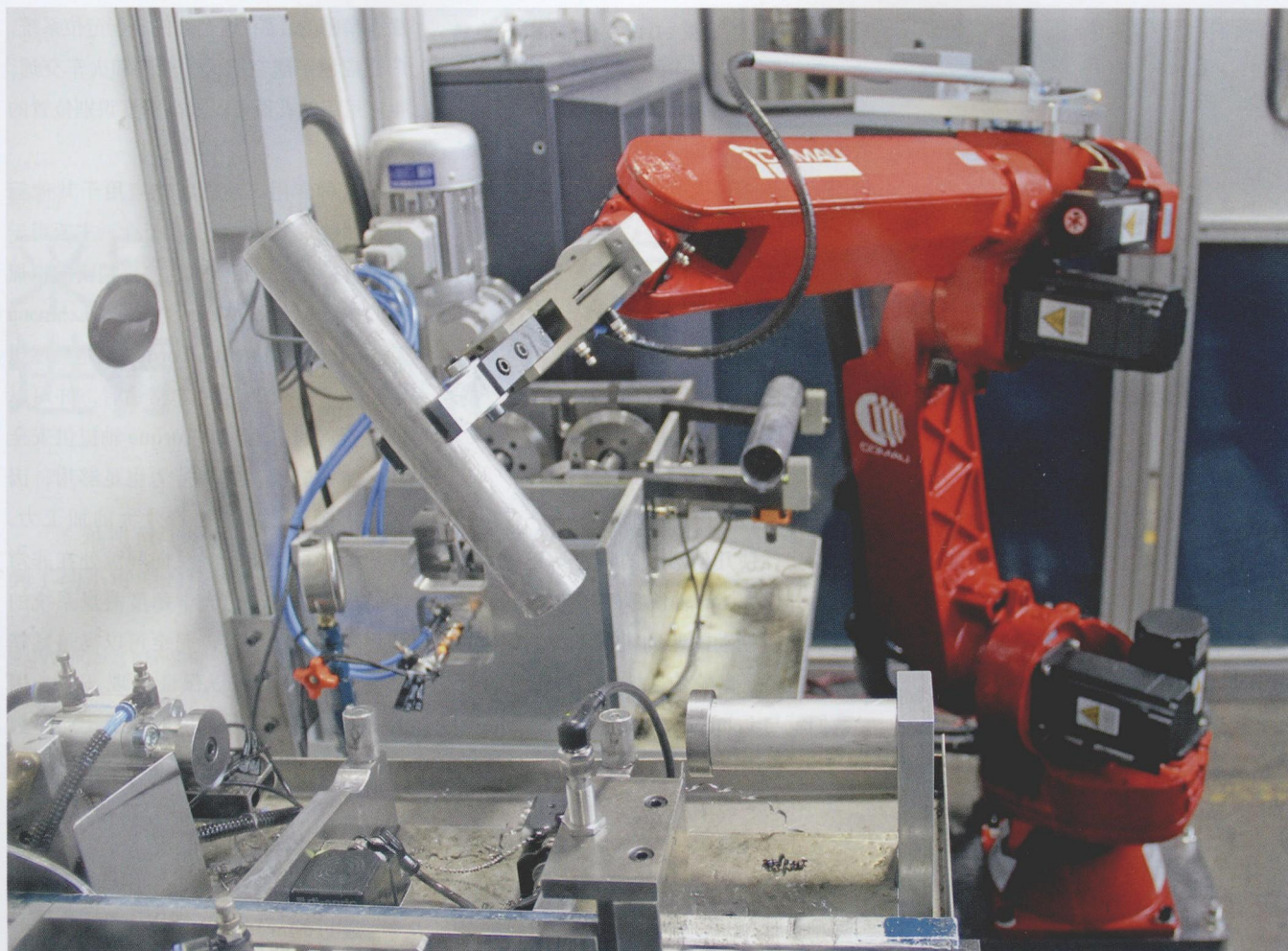
一台中间驱动的车床设备，其装载轴通过 Comau 公司的 NS12 型机器人进行喂料
