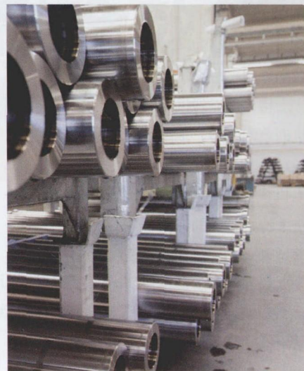
图 4 在 ML500 型 TBT 深孔钻机床上完成钻孔加工的 GLUMANN 的工件
