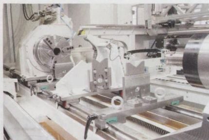
图 2 ML500 型机床工作区域包含尾架、安装在最左端的三爪卡盘和自定心固定托架
