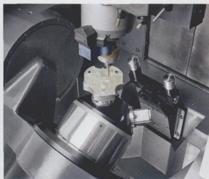
图 2 特有的复合加工技术集先进材料的超声磨削及 HSC 铣削功能于一身，标配 42 000 r/min 主轴
