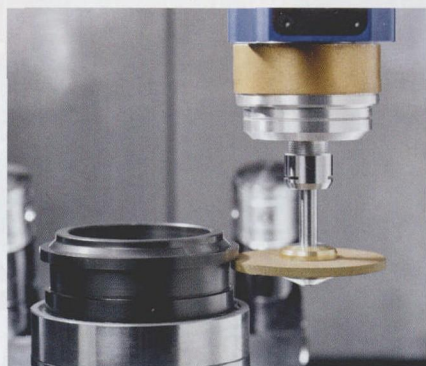
图 3 适用于外圆 / 内圆圆柱磨削的“MT 选配”；ULTRASONIC 20 linear 可一次装卡完成旋转对称件的磨削和钻孔的完整加工
