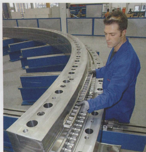
图3 装配工人将各个环与滚柱和其他部件组装在一起，形成一个成品轴承
