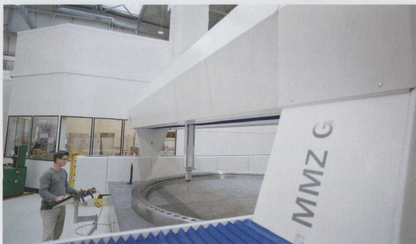
图2 ZEISS MMZ G 三坐标测量机的X、Y轴均长达6 m
