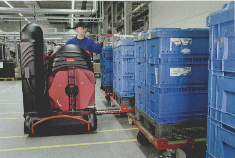
图 3 新的“ErgoPack Air”包装机装有一个获得专利权的双链式悬挂，该双链式悬挂可自由悬挂着在托盘下驶过
