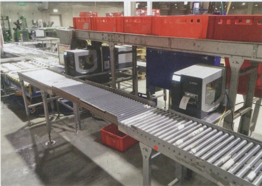
图 1 为货品覆盖上塑料纸包装，然后进行包装作业和打上正确的标签：这一切均在一个流水式作业流程内完成
