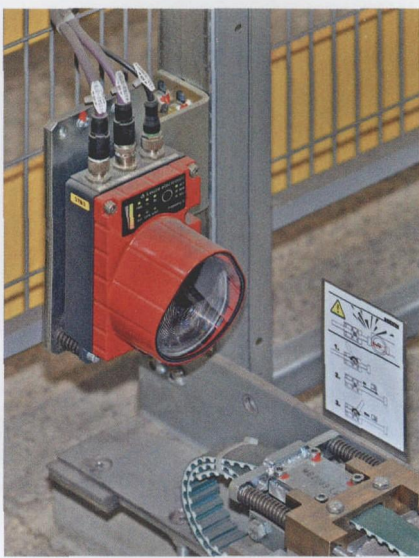
图 5 在 Winkler 公司中央库房的新建项目的很多位置上都设置了 Leuze Electronic 有限公司研制的如数据光栅和跟踪装置这样的传感器
