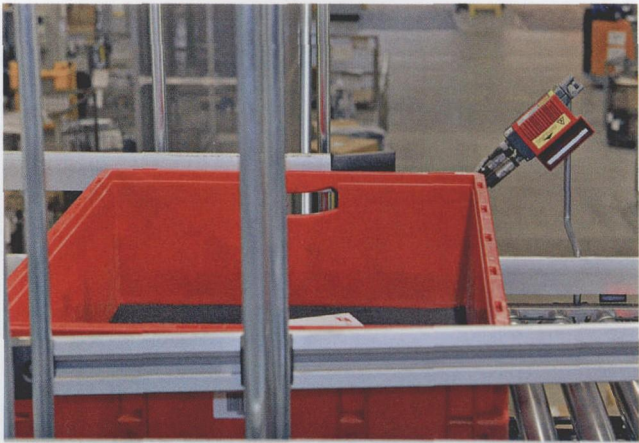
图 4 BCL 304i 型条码识读器通过采取斜置状态，对标签位置变化的容器有一个大的视野
