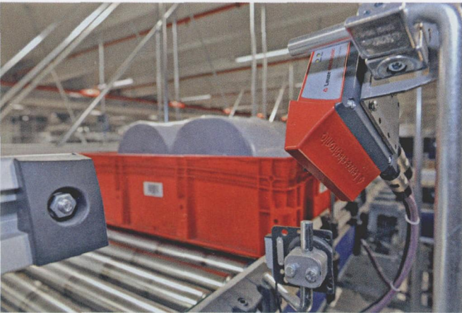
图 3 在 Winkler 公司中央库房的新建项目中采用了 Leuze Electronic 有限公司研制的新型 BCL 304i 型条码识读器
