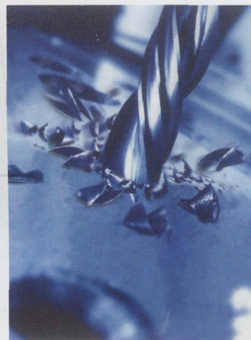
图4 可干式加工的钻铰刀
