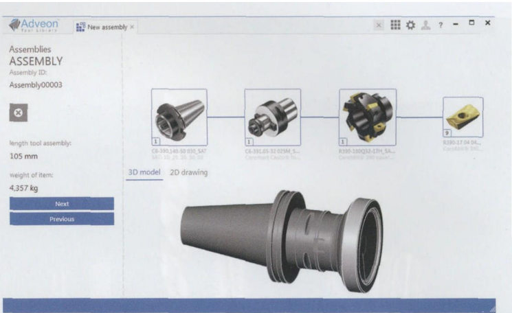
图 2 与其他刀具库应用程序一样，Sandvik Coromant 的 Adveon 软件可用来创建采用 2D 和 3D 形式的刀具装置。这些刀具装置可提供数据和数字模型，用于其他应用程序，如数控机床编程的计算机辅助制造软件、刀具供应管理系统或模拟程序
