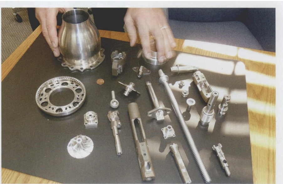
图 1 SMP 公司能生产直径最大为 8 in、长度为 2 ft 的零件，这些零件是在该公司的 Nakamura-Tome 多任务机床上生产出来的
