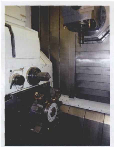
图 2 我们发现在这台 Nakamura-Tome Super NTMx 多功能机床上的主轴和左侧次轴下方有一个转塔，而在顶部第三个主轴上是完全沿着 B 轴方向来加工的
