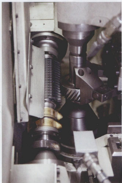
Artis 公司将多个传感器与专为检测干湿圆柱齿轮的软件结合起来, 该软件为磨损或损坏的刀具导致的各种异常而设计
