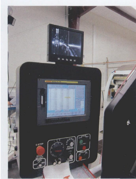
图 3 当使用非常小的刀具或设置异常时，在设置过程中使用具有 13 倍放大倍数的摄像头是非常有帮助的。另外，还可实时观察加工作业，尽管在使用了冷却剂时要实现这一目的是非常困难的
