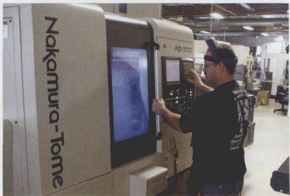
图2 AS-200 设计带有 10.4 in 高分辨率液晶显示屏和最新 FANUC OiTD 控制器，赋予了高功能性和快速处理速度，机床的 NT Nurse II 软件提供用户友好型操作、编程和产品支持。此外，MT 工作导航软件帮助零件方便设置，而不需要夹具
