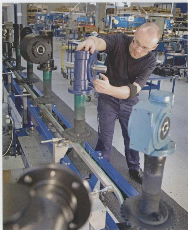
图1 传动装置在机器人喷漆之前，员工会对其外表面进行检查
