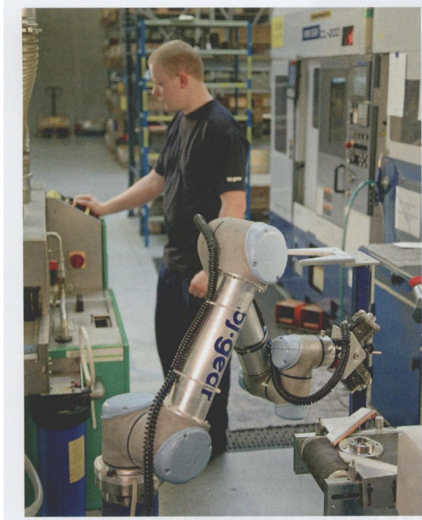
图 2 BJ-Gear 延长了老旧的，但是可运转设备的使用期限，并且在机器人的帮助下创造了自动化生产室
