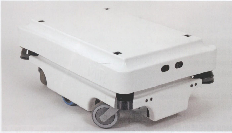
图 2 Universal Robots 的移动机器人 MiR100 是为了应用在物流和生产，以及医疗应用而研发的
