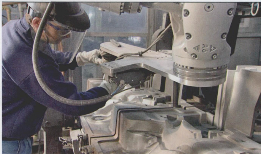
图6 汽车生产商 BMW 在干冰清洁时使用了 MRK 应用
