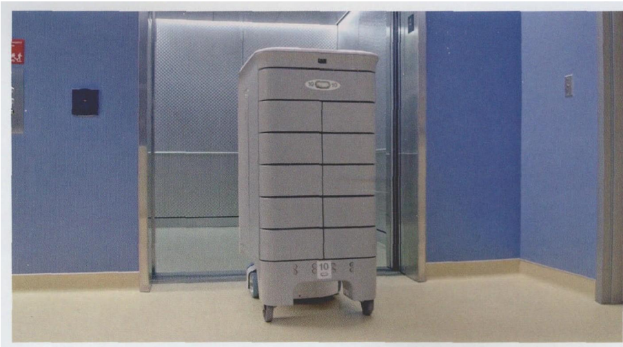
图 2 通过 WiFi 连接, Aethon 公司的移动机器人 Tug 可以独自呼叫电梯
