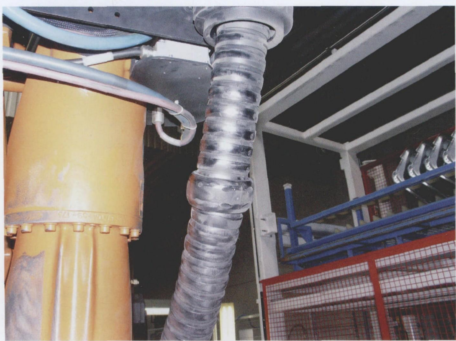
图 6 抗冲击、耐磨损：保护装置在极端机器人移动过程中提供额外的保护
