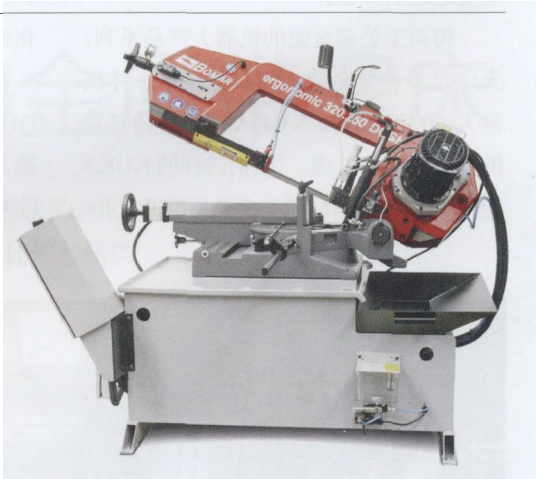
图 2 带锯配有可旋转支座，旋转完成多种角度的切割，避免对台面造成损伤
