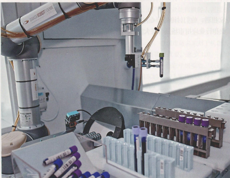
图 1 在位于哥本哈根的 Gentofte 大学医院，两台 UR5 型机器人正快速处理血液样本
